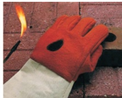
COMFOflex postava ne gori niti nakon 4 sec izloženosti otvorenom plamenu
